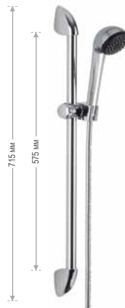
311F 311M Душевая стойка с душевой лейкой с силиконовыми наконечниками обеспечивающими профилактику известковых отложений, из хромированной латуни.
