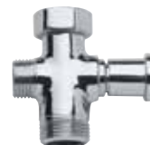
316 A Переключатель (дивертер) воды с излива на душ, к поворотному изливу Ø18мм, 3/4 нар. x 3/4 внут. x 1/2 нар., автоматический (с пружиной).
