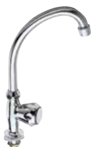
54 EX Кран для кухни с одной вентильной головкой 1/2, монтаж на бортик, высокий поворотный J-образный излив, с аэратором.
