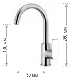
D 72 C Смеситель однорычажный для кухни, U-образный короткий, поворотный, изогнутый излив.
