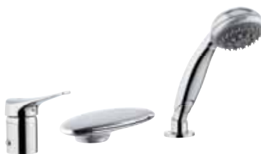
G 07 4 UF Смеситель однорычажный для установки на борт ванны, тяжелый литой излив с переключателем воды с эффектом водопада, с гидромассажной душевой лейкой с силиконовыми наконечниками обеспечивающими профилактику известковых отложений, 4 режима работы.
