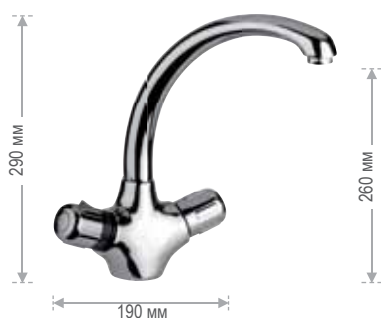
Смеситель термостатический для кухни, с поворотным высоким изливом.
