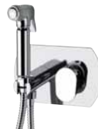
L 60 Комплект встраиваемого смесителя для душа-пистолета: душ-пистолет арт. 332OL, душевой кронштейн – водозабор на пластине из хромированной латуни, гибкий шланг 120 см.
